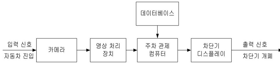
자동 주차 관제 시스템 보안 시스템 블록선도
